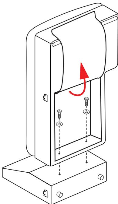
Канapé поставить на угловую спинку, открыть снизу канapé молнию и закрепить спинку. Выровнять места стыковки и затем затянуть болты.
