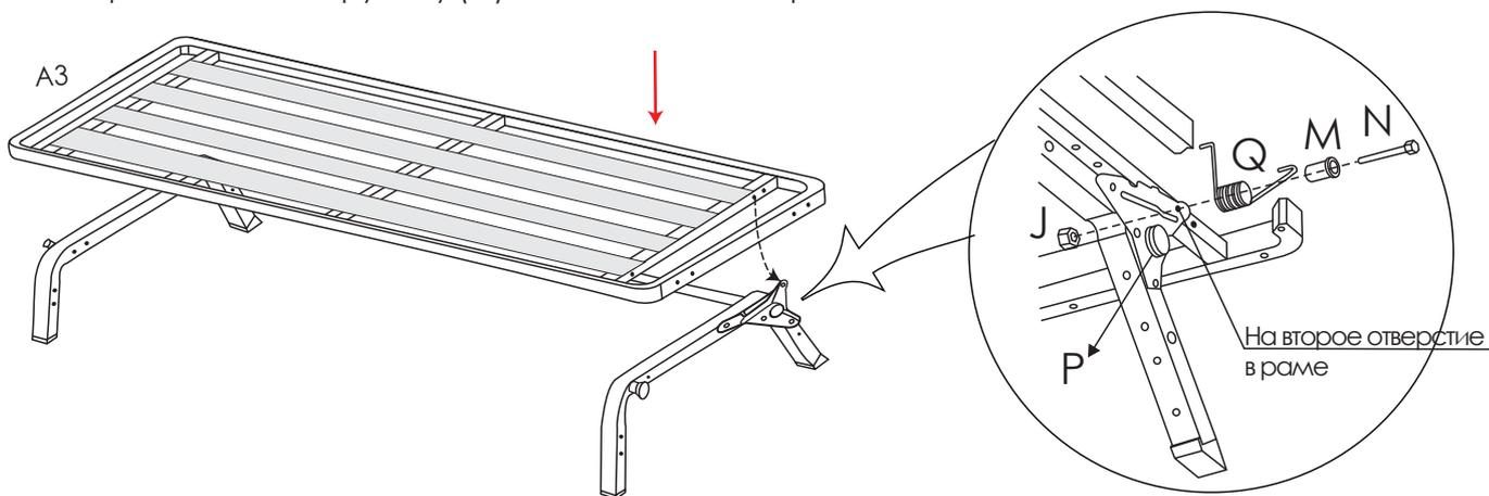
7. На раму (A3) закрепить петли (V) болтами M6x35 (L) и гайками M6 (J).
