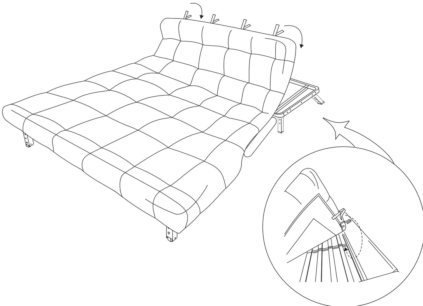
5. Поднять сиденье и зафиксировать царгу к передним ножкам двумя болтами M6x20 (D1).
