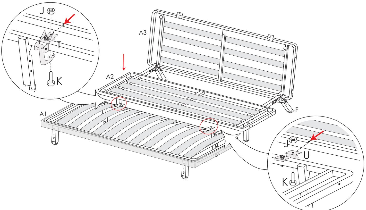
11. Опустить раму (A3) на ноги (E, F) и закрепить её с рамой (A2) в местах расположения петель (V) болтами M6x35 (L) и гайками M6 (J).
