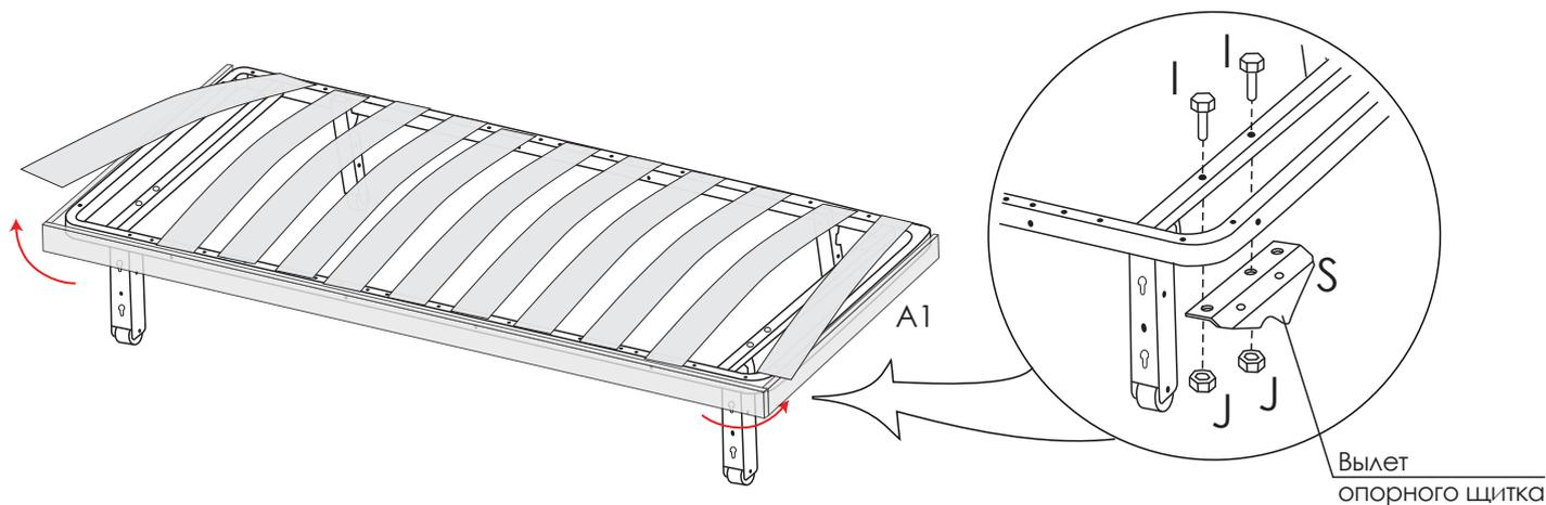
4. Закрепить на ноги (E, F) зацепные ролики (X) при помощи винтов ATC Diablo M8x58 (Y) и гаек M8 (H).
