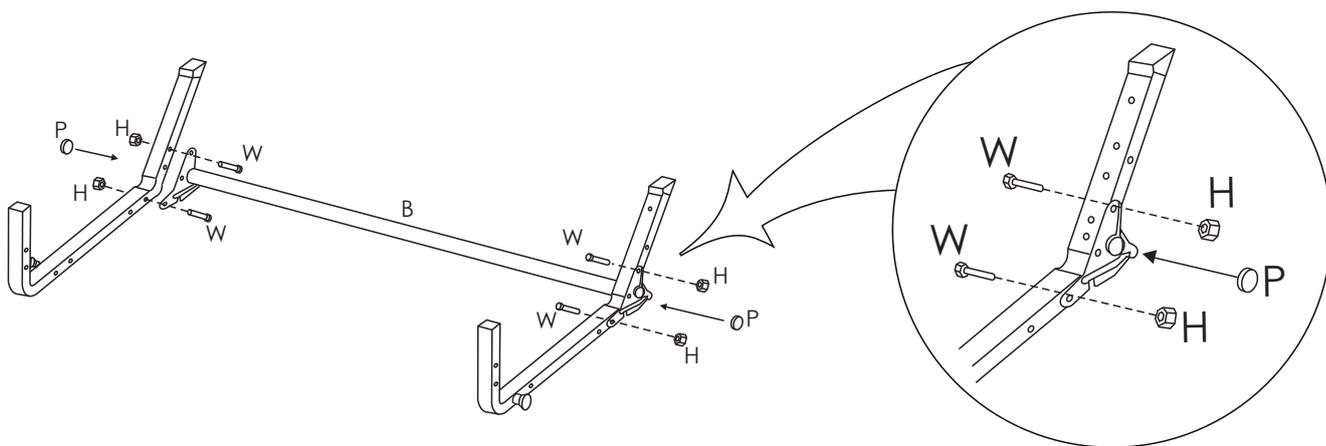
6. Перевернуть штангу с ногами, опустить на нее раму (A3). Закрепить раму (A3) латами вверх при помощи болтов M6x65 (N) и других деталей, указанных на схеме.
