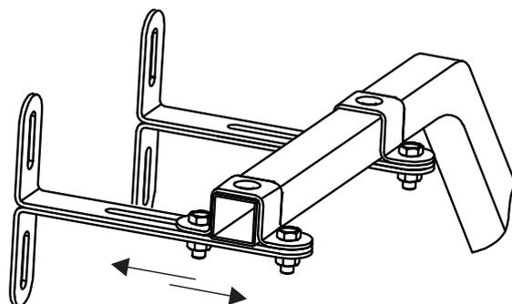
Крепления Пикколо нужно отрегулировать для неплотного прилегания подлокотника к ткани чехла дивана. Это обеспечит легкость раскладывания механизма.
