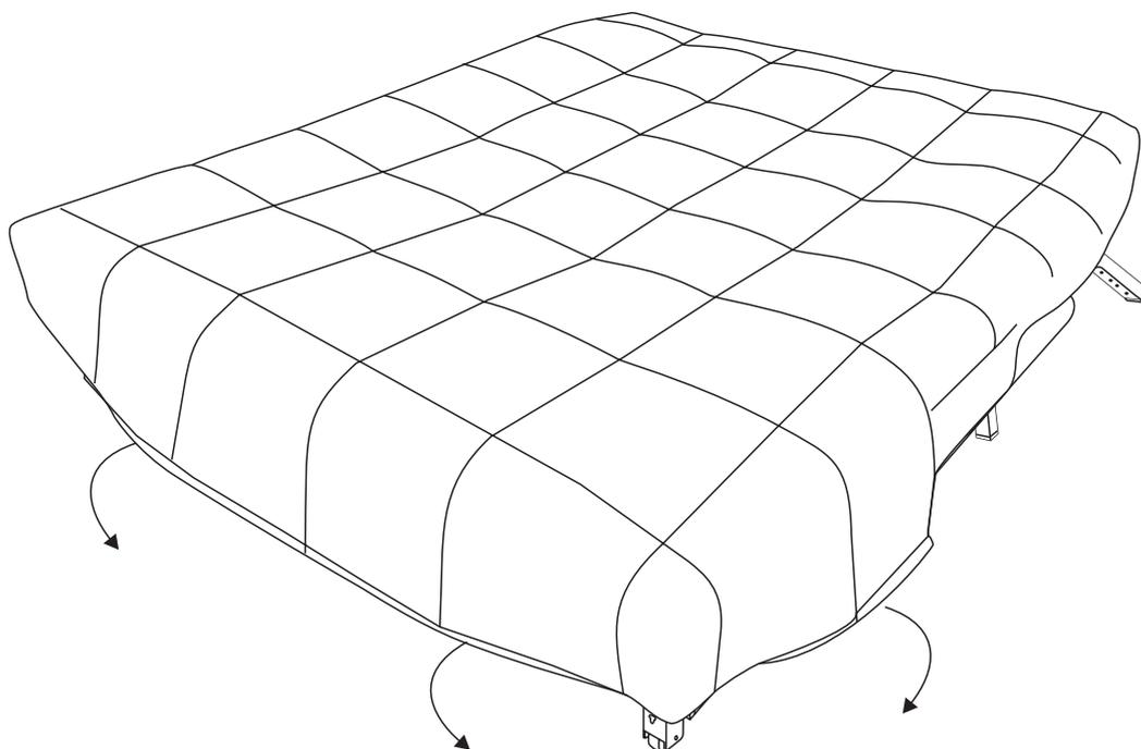
4. Верхнюю часть матраса у прямой части дивана закрепить на раме с помощью контактных лент.
